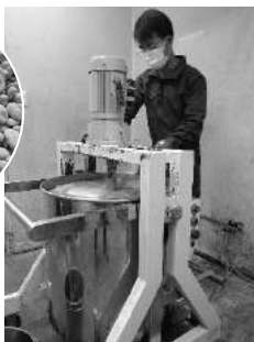
大きな釜で 使用済み油を加熱し製造 (2020年撮影)
