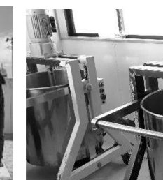
使用済み油に苛性ソーダを入れて石けんを焚く釜が設置された
