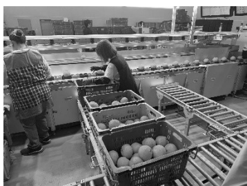
柑橘の仕分けをし出荷する選果場 人の手だけでなく、 特殊なカメラも使用して検査する
