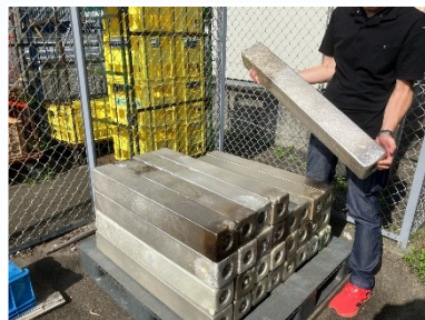
廃棄するシッパーは熔融機（左）に かけ、上のように固体化して資源と して出荷します。
